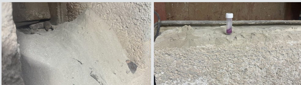
Losse aslaag op een onderdeel in het ovengebied. Detectie in as in het ovengebied, monsterbuisje met kleuromslag.
