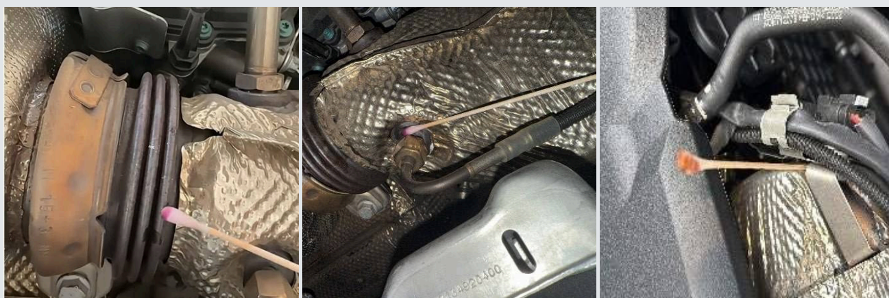
Positieve chroom(VI) -snelttests in de motorruimte van personenauto's.
