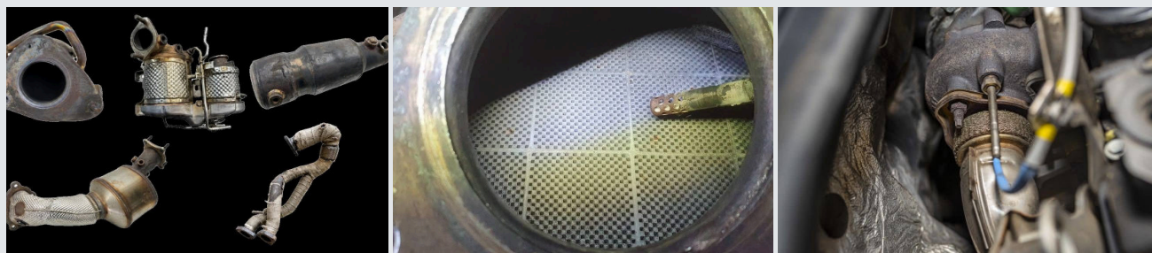
Typische gebruikte onderdelen uit de uitlaatlijn; gelige afzettingen op het roetfilter; sensor met afzettingen op de geïsoleerde uitlaatpijp.
